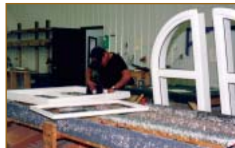
Vern Smith prépare un châssis de fenêtre Northwind de Little Fork pour l'installation des vitres.
