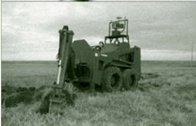
En haut : appareil de mise à l'épreuve de bottes antimines. Au milieu : résultats d'une mise à l'épreuve de bottes antimines. En bas : essais d'une méthode d'excavation avec substituts de mines.
