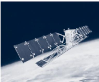
Le satellite d'observation de la Terre RADARSAT-1, lancé en novembre 1995, utilise un puissant instrument hyperfréquence, le radar à synthèse d'ouverture, pour capter des images de la Terre, jour et nuit, et dans toutes conditions climatiques.
