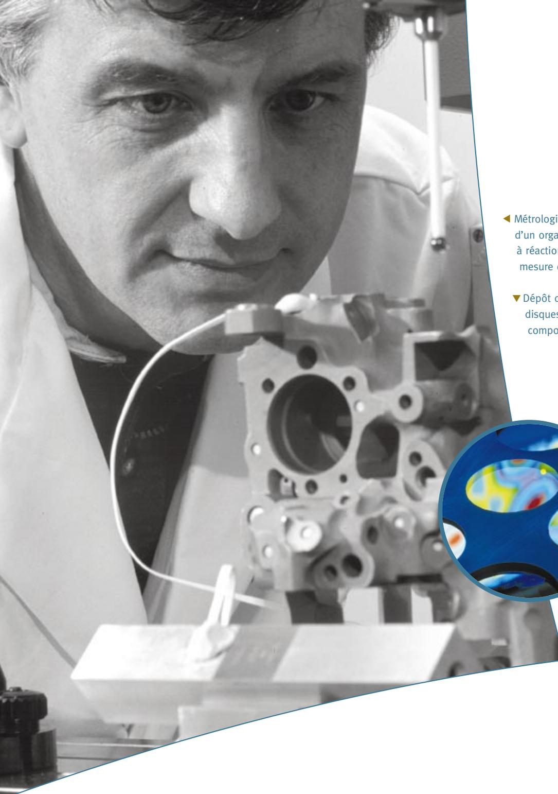
◀ Métrologie dimensionnelle – Évaluation d'un organe complexe d'un moteur à réaction au moyen de l'appareil de mesure des coordonnées de l'ÉN.M.
