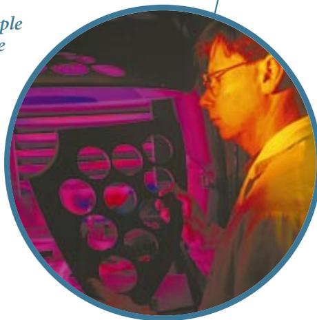
Un chercheur de l'ISM examine un substrat utilisé lors du revêtement par dépôt ionique de filtres de très haute qualité destinés au secteur des télécommunications.
