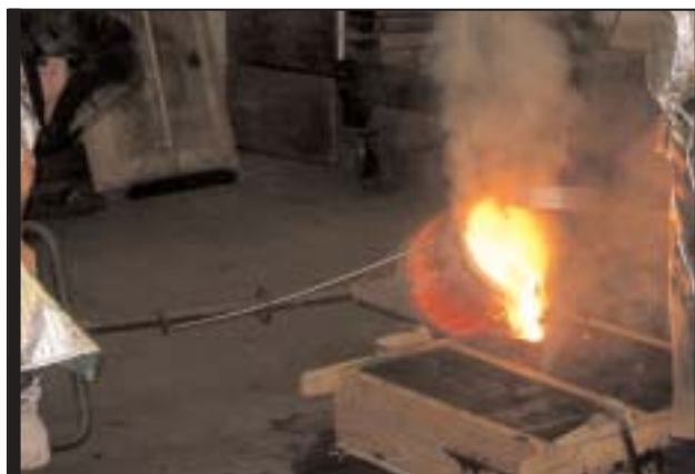
Gord Graham, Glenn Morgan et le Matc Trevor Ford portent des combinaisons de protection pour verser le métal liquide dans les moules.
