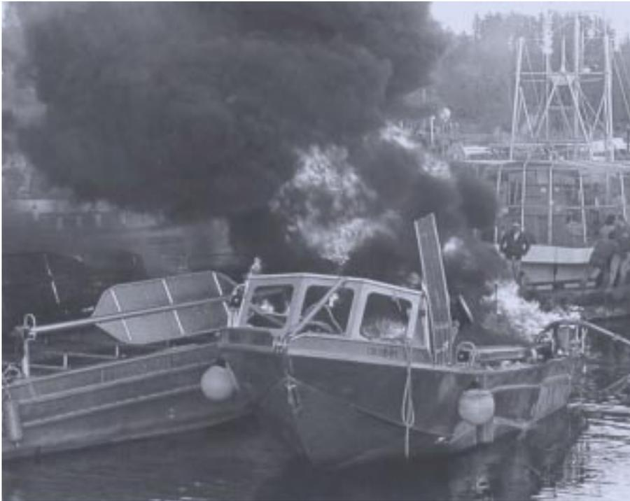
Lorsque le patron a lancé le moteur bâbord, il s'est produit une explosion suivie d'un incendie alimenté par l'essence. La force de l'explosion a projeté le patron de l'embarcation sur le pont d'un autre navire. Heureusement, une toile s'était enroulée autour du patron du navire au moment de l'explosion, c'est ce qui l'a empêché de subir des brûlures, mais il a souffert une blessure au genou causée par un éclat. Le *Sha 122* a été lourdement endommagé et est considéré une perte totale.
