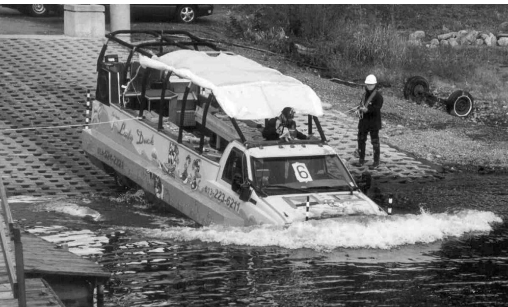
Mise à l'eau à 8 km/h avec la visière submergée d'environ 25 mm
