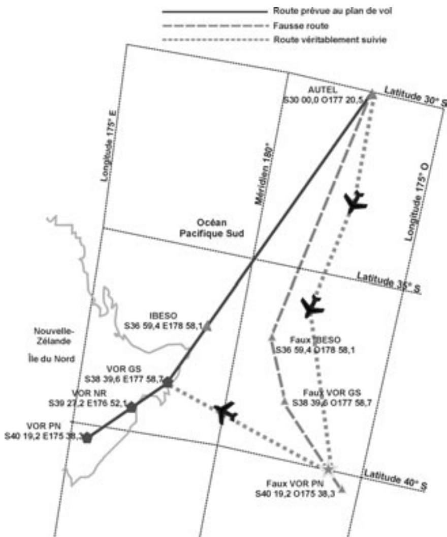
Route prévue au plan de vol et route véritablement suivie
