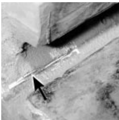
Le même défaut de coulée après des travaux de recherche effectués à l'aide d'une meule à rectifier les matrices. La flèche indique la présence possible d'une fissure.
