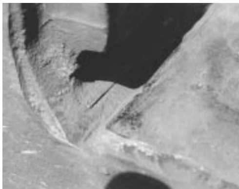
Défaut de coulée décelé dans l'arrondi entre la partie supérieure et le montant extérieur de la plaque de garde.
