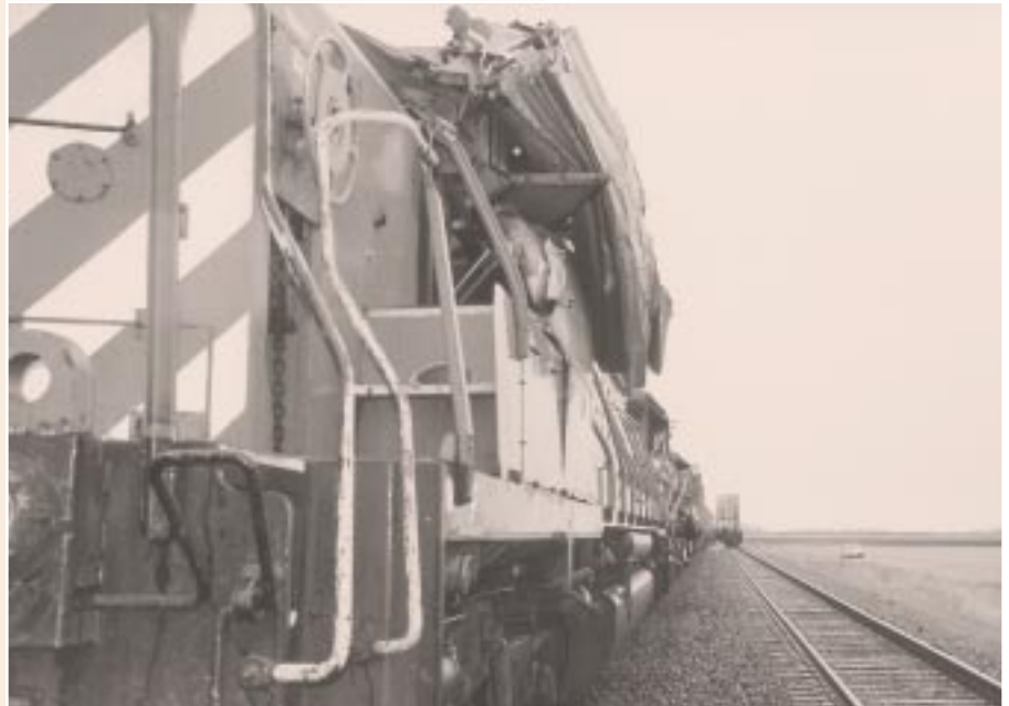
La cabine de la locomotive de tête du train 472 est enveloppée de débris d'un conteneur du train 471.
