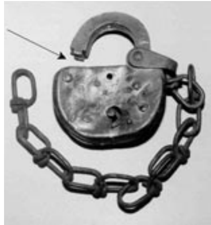
Cadenas d'aiguillage endommagé. Notez les dommages subis par le mécanisme de fermeture de l'arceau (flèche).
