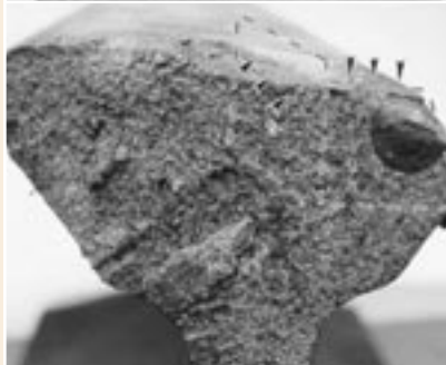
Défaut transversal affectant 5 % de la surface de rupture du rail.
