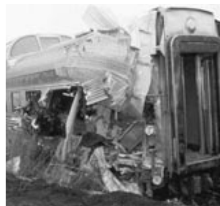
Dommages causés à la voiture Skyline suite au choc contre le mur de fondation d'un commerce de fournitures agricoles.
