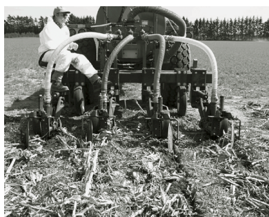
Le travail du sol par des méthodes antiérosion perturbe moins le sol que les méthodes traditionnelles.
