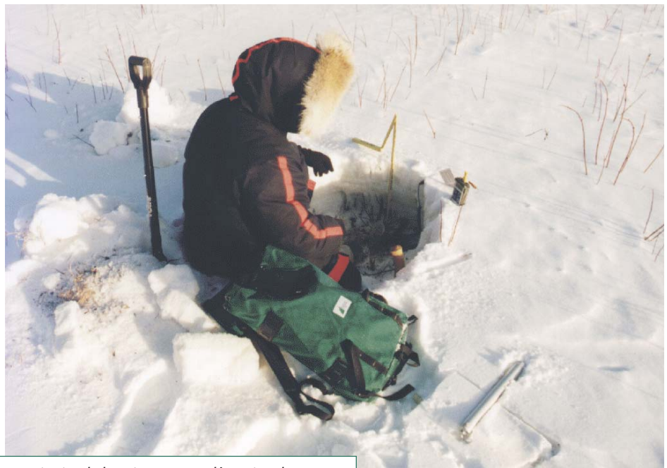
Échantillonnage in situ de la neige pour en déterminer la teneur en eau en vue de la vérification au sol des mesures satellitaires.
