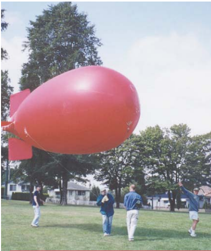
Des employés du Service météorologique du Canada lancent une sonde captive pendant l'étude Pacifique 2001, pour recueillir des profils détaillés de la température, des vents et de l'humidité dans la couche limite atmosphérique.
