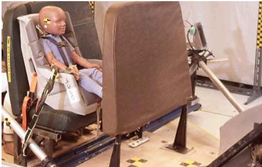
Figure 1 – Installation typique pour un essai
