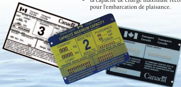
De plus, l'étiquette de capacité confirme que l'embarcation de plaisance est conforme aux exigences des Normes de construction des petits bateaux.
