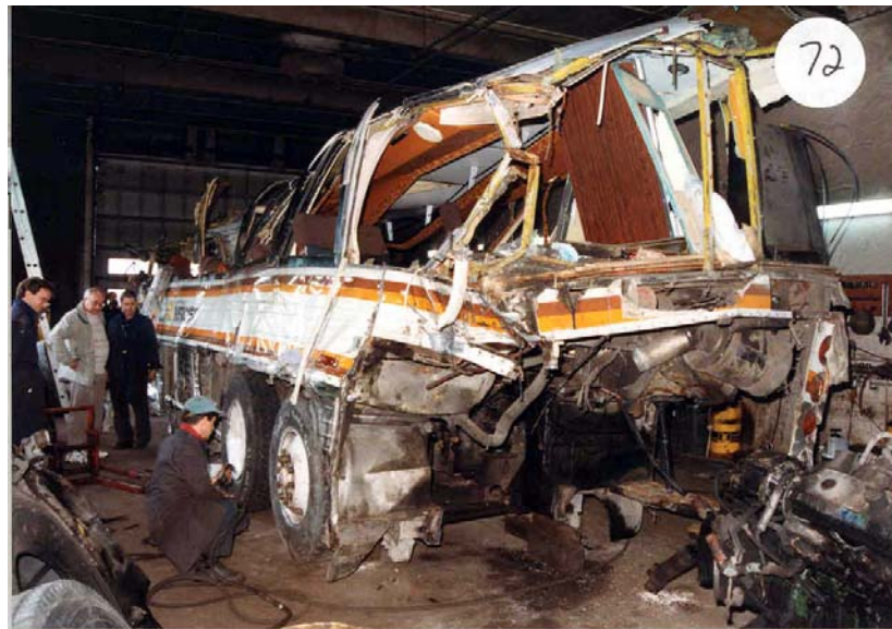
Figure 1 : Cas 1 – Vue arrière à gauche de l'autobus montrant une déformation importante
