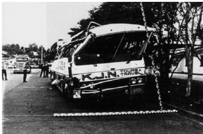
Figure 5 : Devant de l'autobus du Cas 4 montrant la déformation
