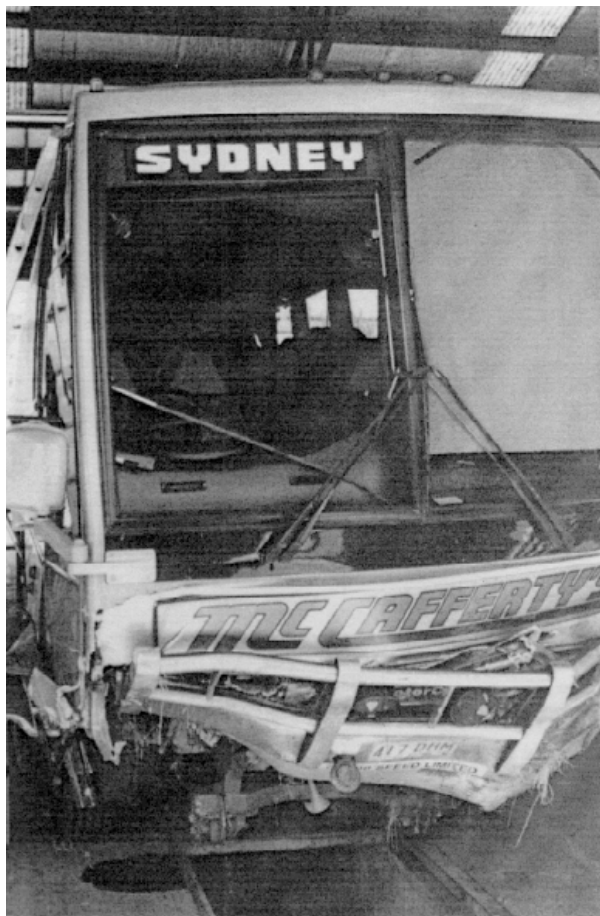
Figure 7 : Avant de l'autobus du Cas 6 montrant une déformation – Vue frontale
