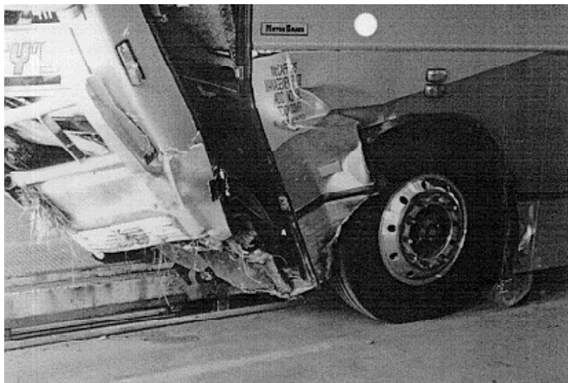
Figure 8 : Avant de l'autobus du Cas 6 montrant une déformation – Vue latérale
