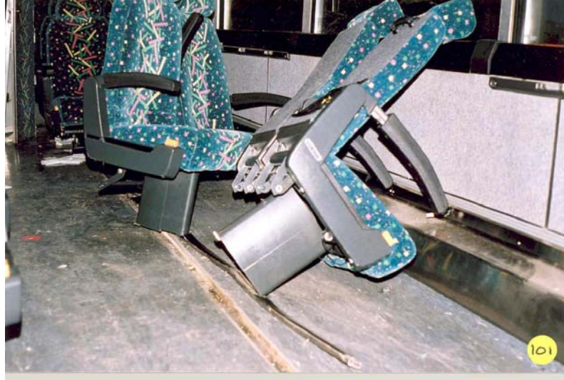
Figure 2 : Cas 4 - Exemple du détachement d'un siège
