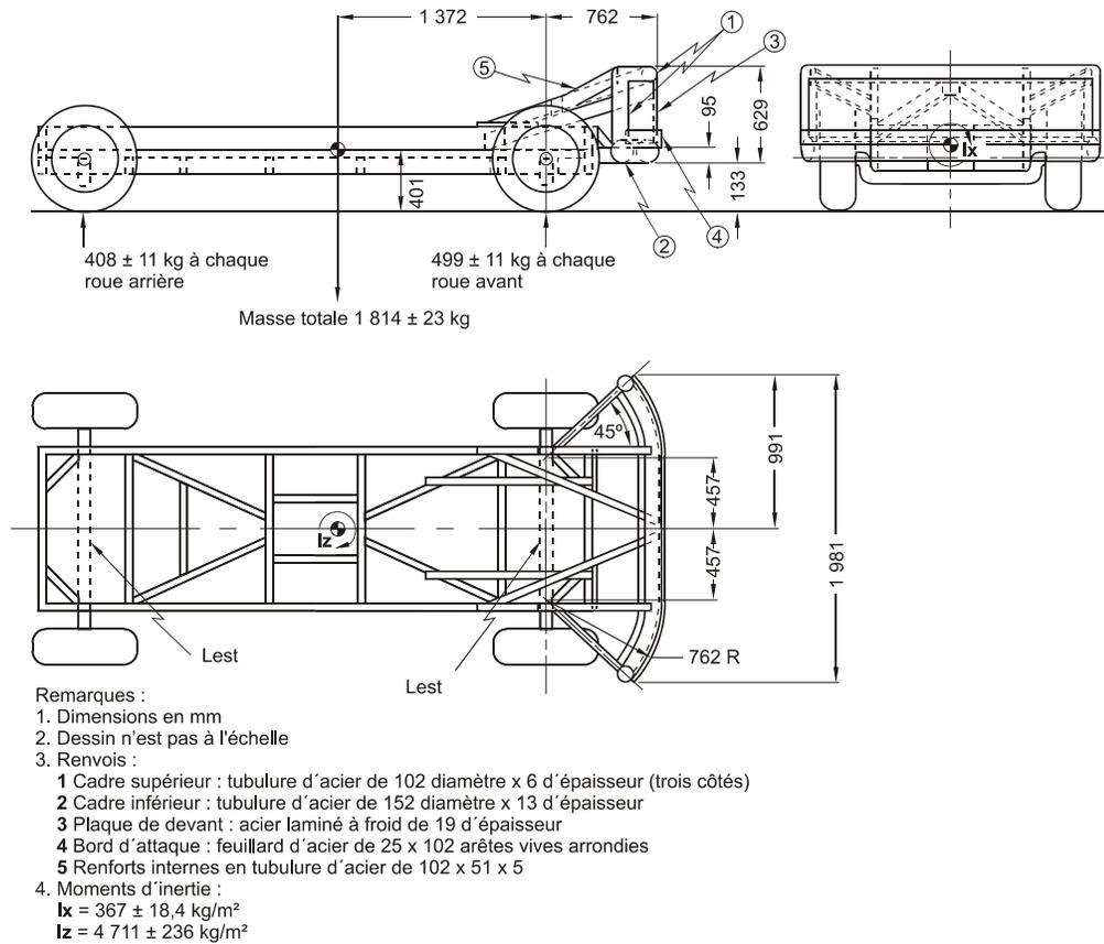
Figure 2 : Chariot ordinaire avec barrière mobile profilée
