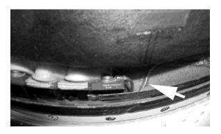
Photo indicates the ground wire can make contact with the glare shield La photo montre le fil de mise à la masse susceptible de faire contact avec l'auvent
