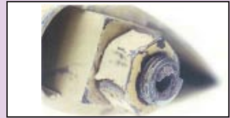
Gros plan des surfaces rompues du hauban droit de l'appareil en cause dans cet accident.
