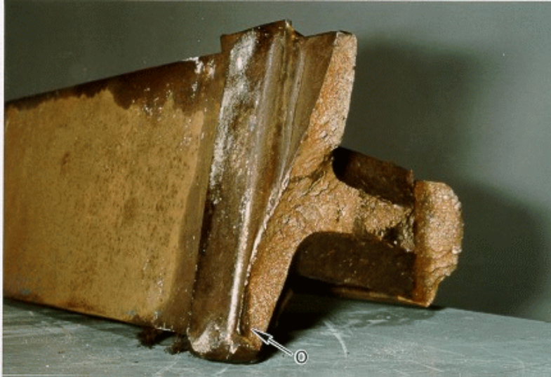
Figure 5 — Emplacement de la préfiissure (O)
