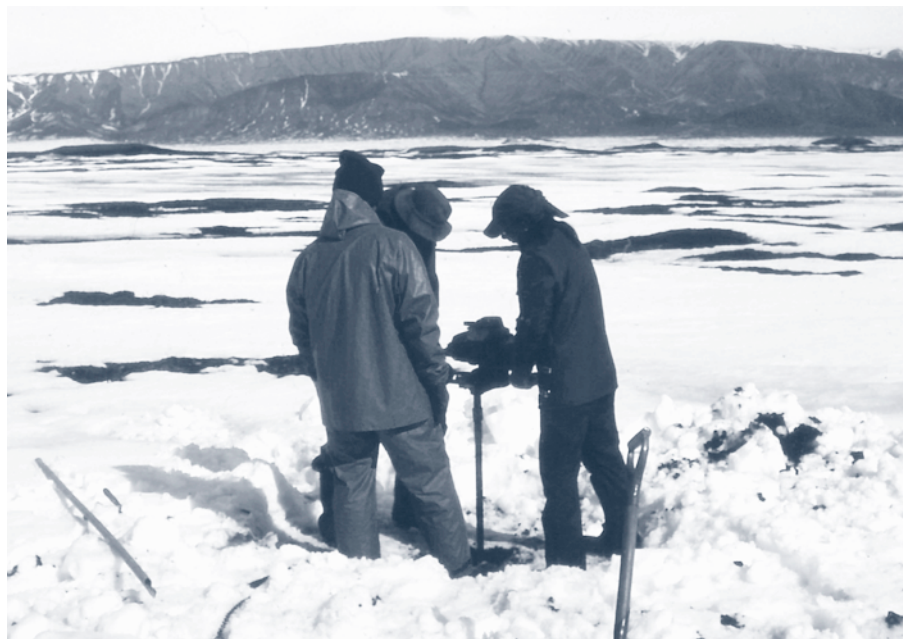
Figure 5 Prélèvement d'une carotte de sédiments du pergélisol. Le carottier a été construit sur mesure par Michel Allard (Université Laval), qui supervise (à gauche). Opérateurs : Daniel Fortier (au centre) et Isabelle Duclos (à droite). Photo : C. Ellis.
