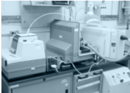
Photos 1 et 2 (de haut en bas) – Mise à l'essai d'un grand assemblage de bagues collectrices. Photo 3 – ATG (analyse thermogravimétrique) et ATD (analyse thermique différentielle) simultanées avec analyse des gaz par spectrométrie de masse et spectrométrie infrarouge à transformée de Fourier.
