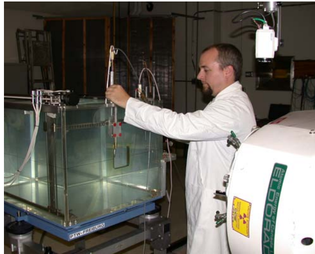
Brad Downton effectue des mesures de mise en service de l'irradiateur à Co-60 après que la source a été remplacée.
