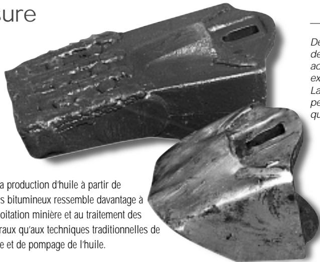
*Dents neuves et dents usées, en acier renforcé, d'un excavateur à roue. La limite d'usure peut être aussi peu que 72 heures.*
