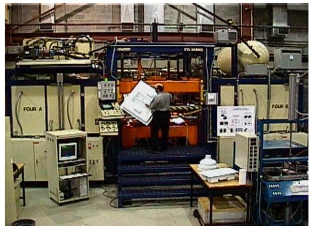
*Machine de thermoformage à deux postes de grandes dimensions*
