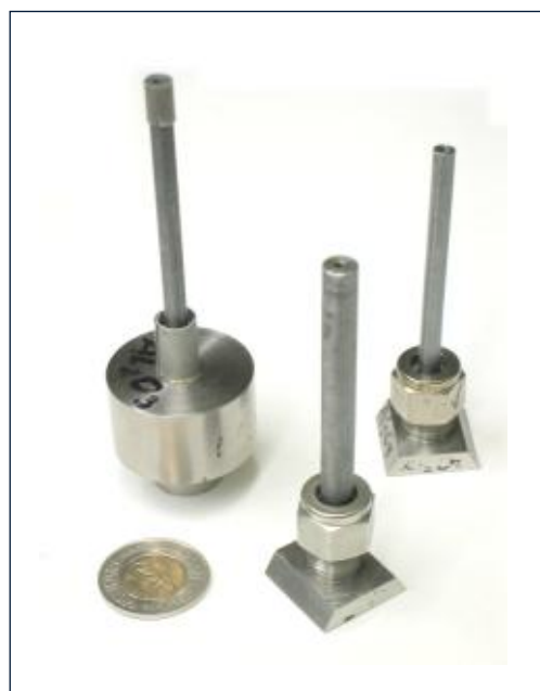
Figure 2 : Boîtes en vanadium servant à contenir des échantillons de poudres
