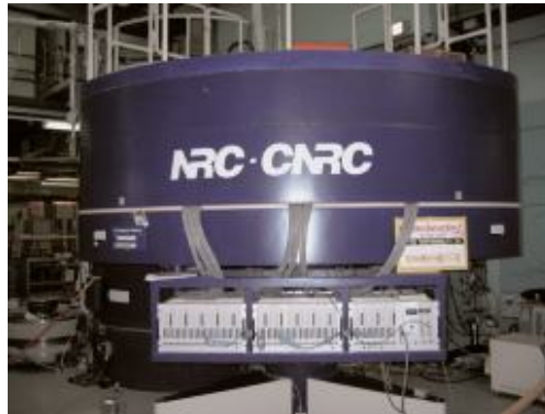
Figure 4 : Diffractomètre neutronique C2.
