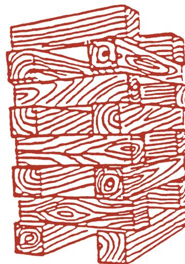
Calage de bois en morceaux de 4 po sur 4 po (10 cm sur 10 cm), ou de 6 po sur 6 po (15 cm sur 15 cm) posés à plat
