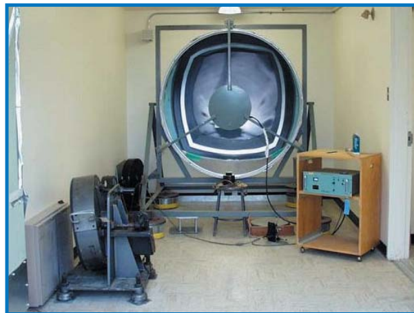
Un miroir parabolique d'un diamètre de 1,5 m sert de source active au couloir de 5,7 km.
