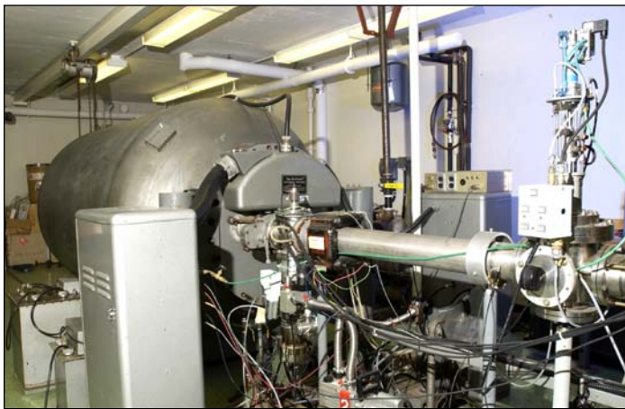
3 MeV Van de Graaff accelerator tank.
