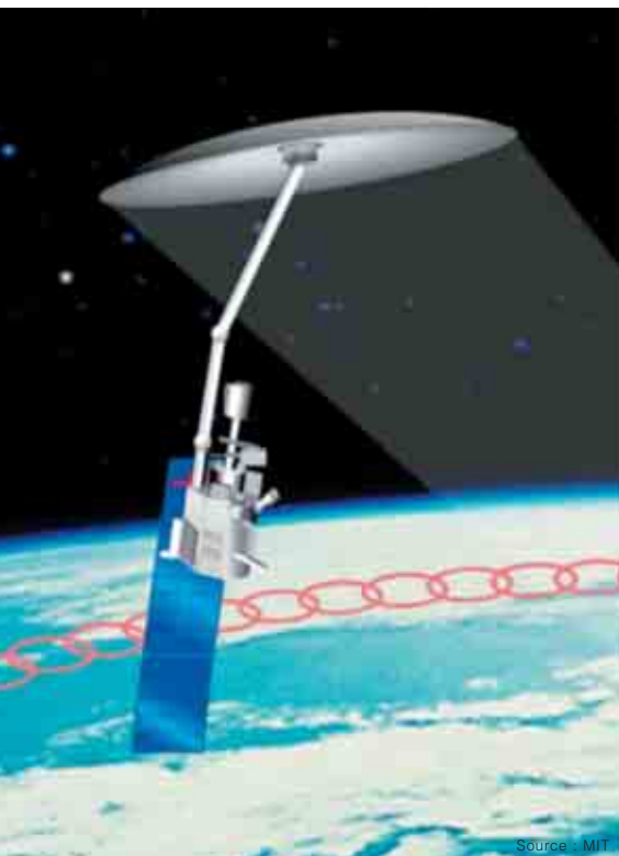
Le satellite HYDROS suivra depuis l'espace la dynamique gel-dégel et mesurera l'humidité du sol à l'échelle de la planète.
