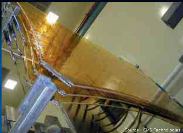
Antenne SAR à membrane en cours de développement chez EMS Technologies à Ste-Anne-de-Bellevue, au Québec.
