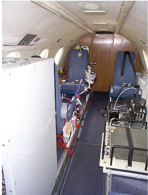
Équipements d'expérience montés dans le Falcon 20
