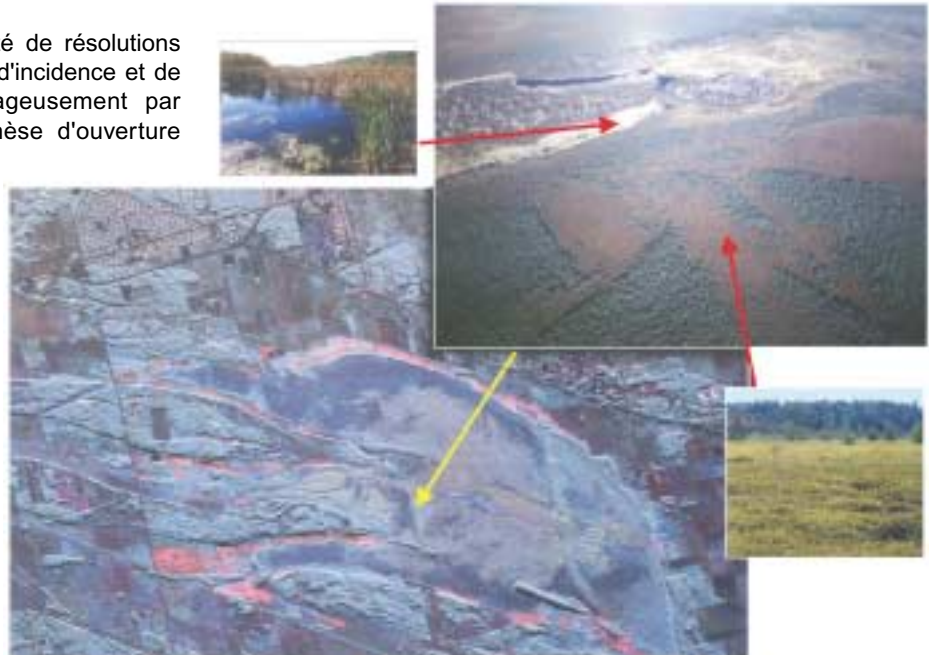
Cartographie de milieux humides sur le site de Mer Bleue, en utilisant une image en composé coloré produite avec données multi-polarisées. (© CCT. Acquisse par le CV-580 RSO en bande-C. Traitée et fournie par le CCT.)
