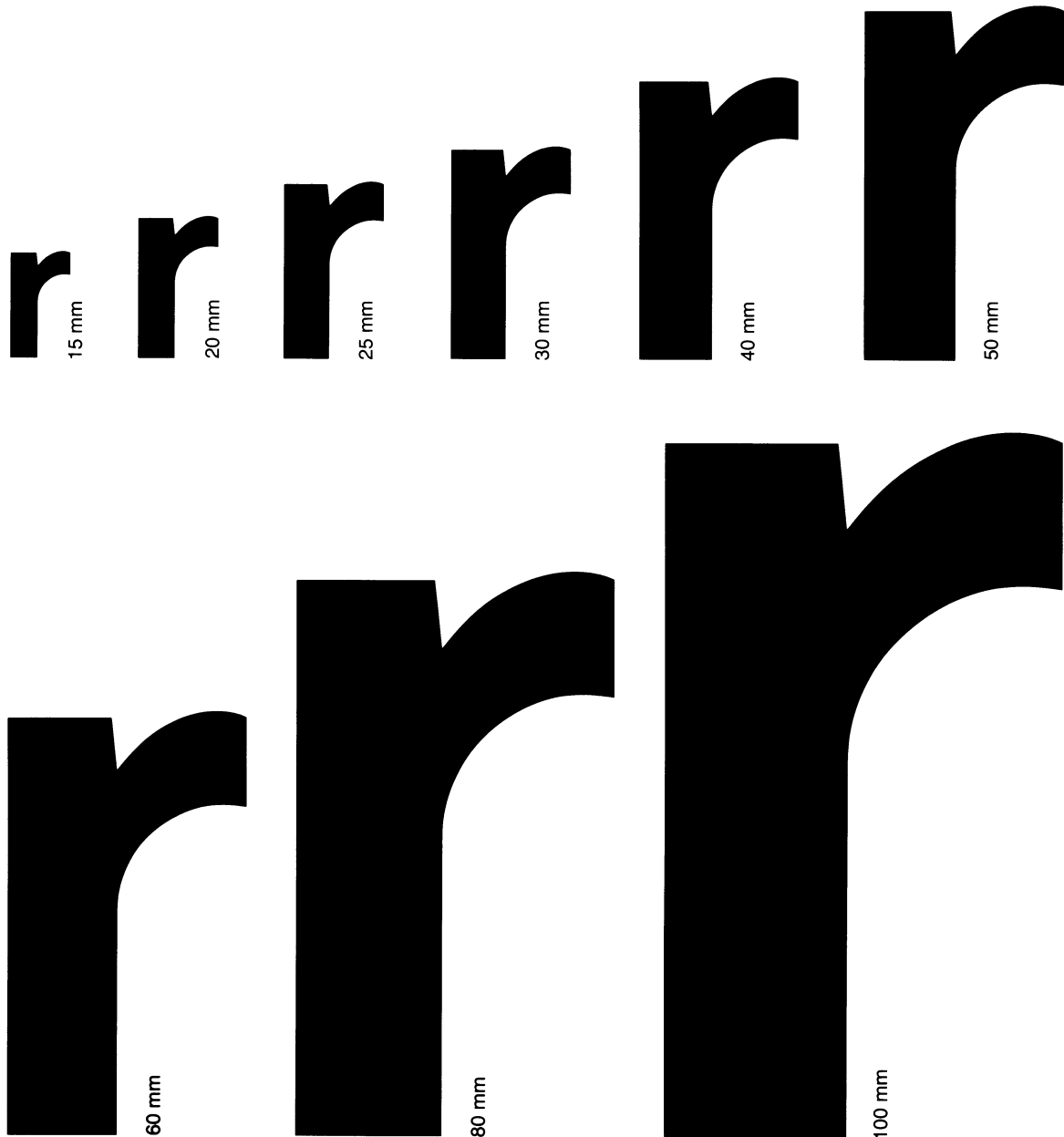
Fig. 11 Commonly used character sizes. Corps des caractères couramment employés.
