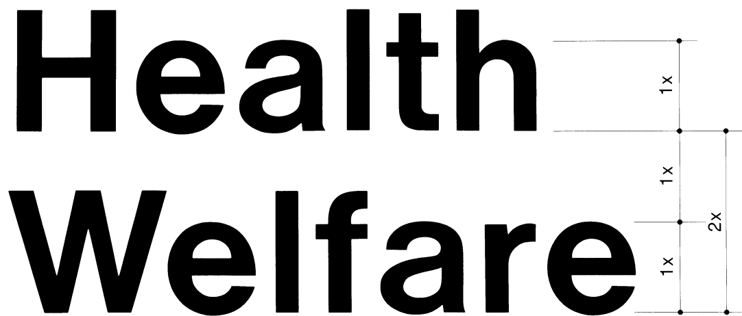
Fig. 7 Spacing of lines. Espacement des lignes.
