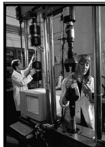
Des employés du Laboratoire d'essais mécaniques du Laboratoire de la technologie des matériaux de CANMET réalisent un essai de fatigue pour un joint soudé (gauche) et un test d'élasticité standard (droite).
