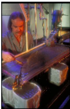
Un scientifique de RNCAN en train de pulvériser et de séparer des échantillons de minéraux sur une nappe d'eau vibrante.
