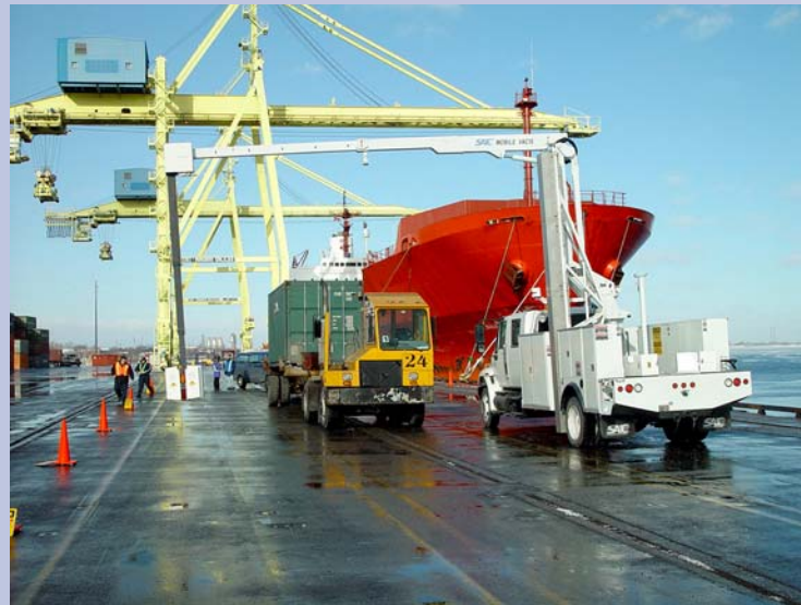
Des agents de l'Agence des services frontaliers du Canada utilisent l'unité mobile d'inspection radiographique du fret VACIS afin de balayer les conteneurs d'expédition au Port de Montréal.
