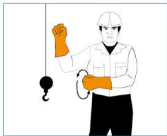
▲ Travel right track (backward) Recul du chariot (en utilisant la chenille droite)
