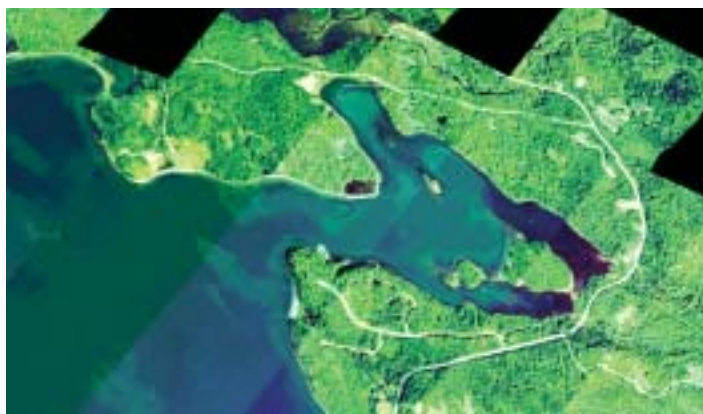
Image, obtenue par imageur spectrographique compact aéroporté (CASI), d'une petite partie du lac Bras d'Or montrant le tracé des limites des caractéristiques sous-marines à des profondeurs de 5-10 m. Ces caractéristiques seront associées à des types d'habitat benthique après vérification in situ et comparaison avec les données du sonar multifaisceaux.
