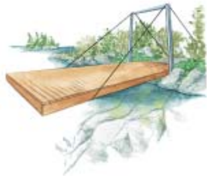
Une tour et des câbles épais maintiennent dans les airs le pont suspendu.
