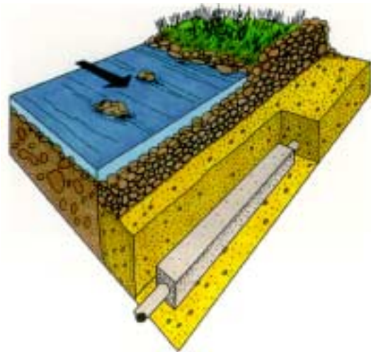
Remblayage d'une traversée de cours d'eau
