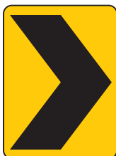
Chevron (flèche) En groupes pour diriger les conducteurs dans les courbes prononcées
