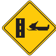
Signal avancé de passage de motoneiges
