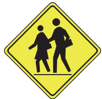
Signal avancé d'un passage pour écoliers
