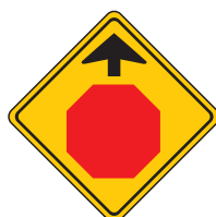
Signal avancé d'arrêt
