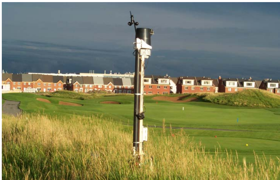
Figure5.2 Station Davis (installée sur le terrain de golf Challenger, Montréal été 2005)
