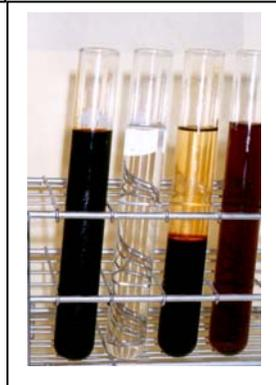
*Figure 2 (à droite) : (de gauche à droite) Biohuile régulière d'Ensyn ; diesel pur ; mélange immiscible et diesel (deux phases) ; combustible obtenu à partir du procédé BDM<sup>mc</sup> (phase unique).*
