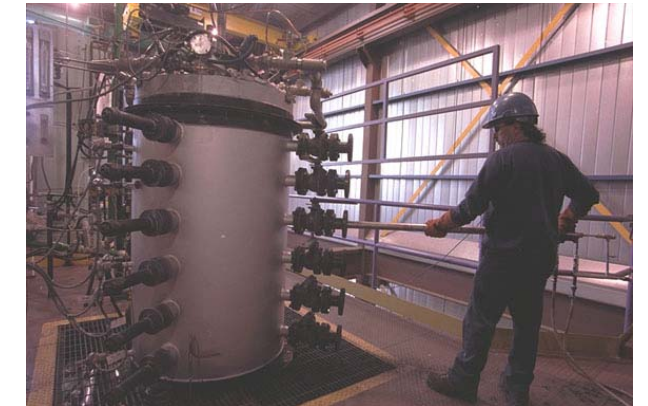
Un membre du GPEE effectue des mesures de la température dans le système vertical de combustion.
