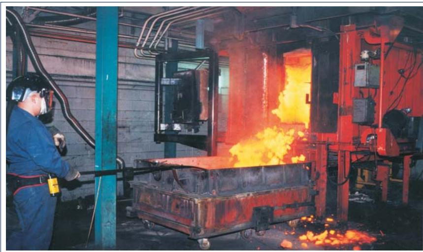
*Décharge au CTEC de coke métallurgique à partir du four pilote à parois mobiles*
