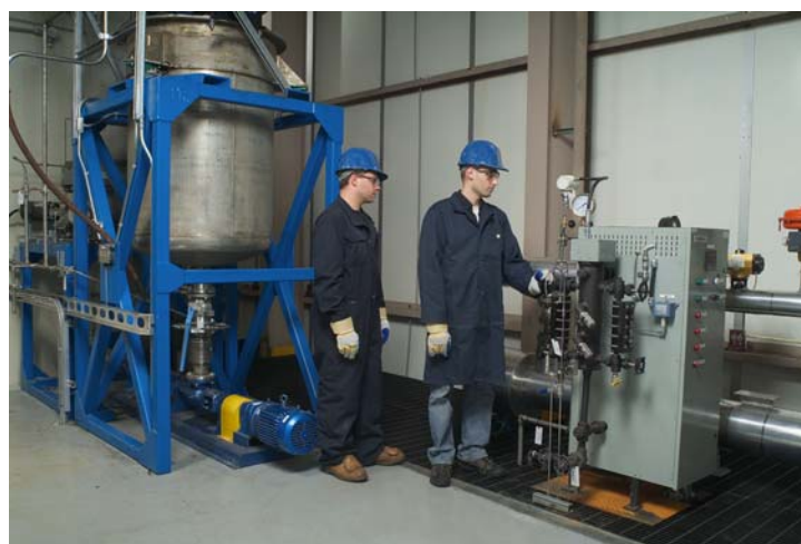
Le gazogène peut fonctionner par alimentation sèche ou par alimentation en bouillie.
