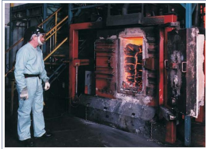
Retrait de coke d'un four à coke de type à fentes.
