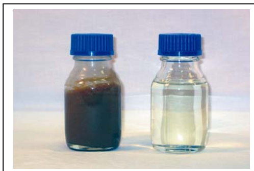
Transformation de graisses de restaurant (à gauche) en SuperCétane (à droite)
