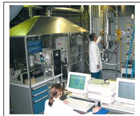
Réacteur automatisé servant à produire l'additif pro-cétane (le SuperCétane)
