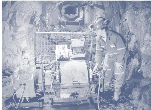
*Développement du racloir automatisé à la Mine-laboratoire de CANMET-LMSM*
