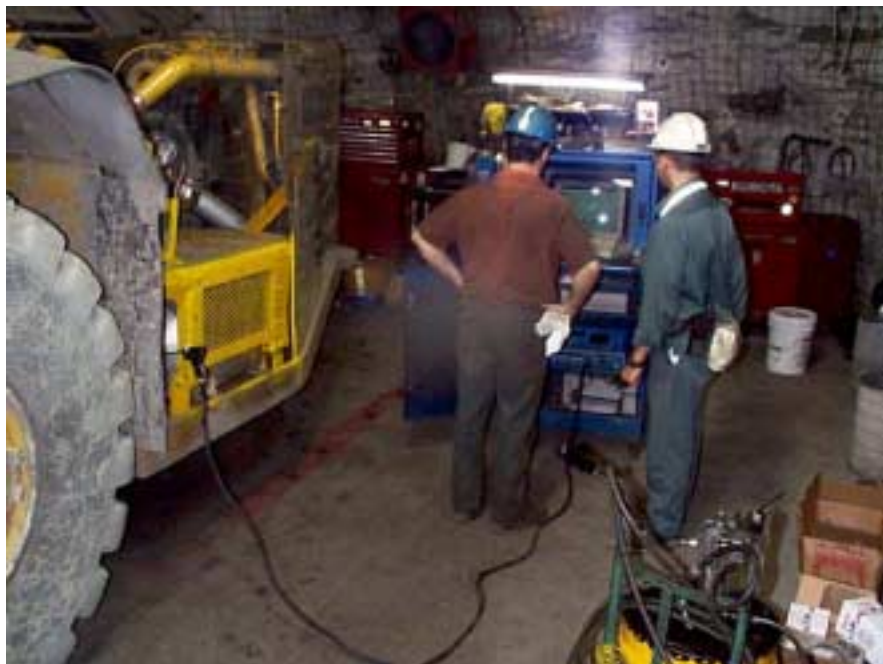
Figure 5. Échantillonnage direct des émissions à l'aide de l'appareil UGAS/ECOM
